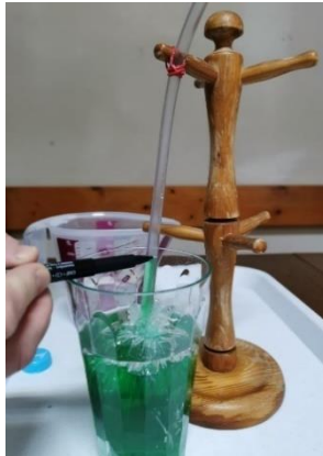
6. ábra A sós víz szintje a gumicsőben.
