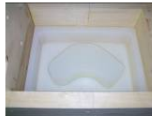
2. Az öntött szilikon matricaforma
