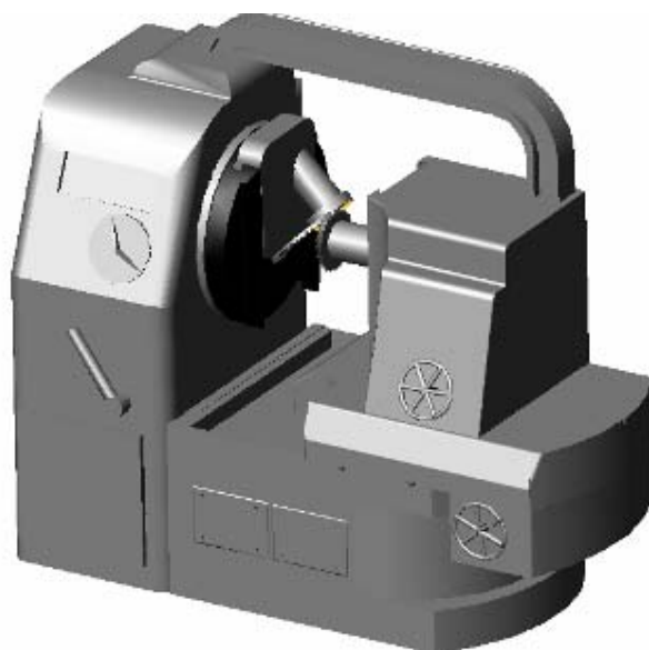
6.ábra. Kúpkerék generálásának szimulálása az Oerlikon Spiromatic gépen
