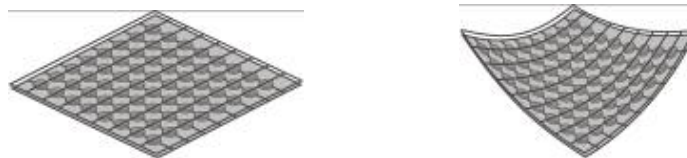
7. ábra: Mátrix elrendezésű erő szenzor.
