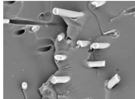
4. ábra 8% nanocső tartalmú PC töretfelülete
