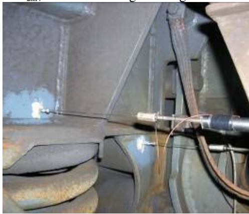
Járműszekrény és forgóvázkeret közötti relatív elmozdulás mérése
