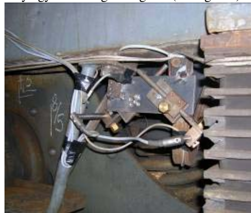
A felműszerezett 1-es forgóváz
