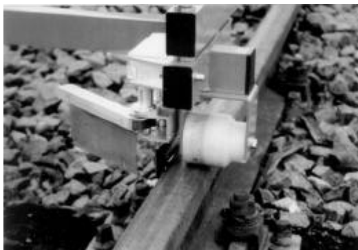
2. kép A TrackScan vágánygeometriai mérőkészülék mérőfeje
