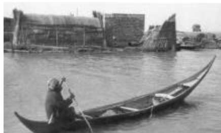
A Hit környéki források aszfaltjával vízmentesített csónak
