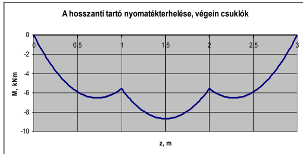
8. ábra A merevítő rudak nyomatékterhelése
