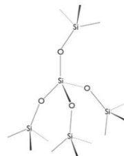
A szilícium és az oxigén kapcsolódása a szilícium-dioxidban
