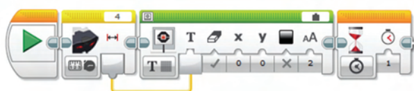
48. ábra: Az infravörös érzékelő által mért távolság (a visszatérési érték) kiírása
