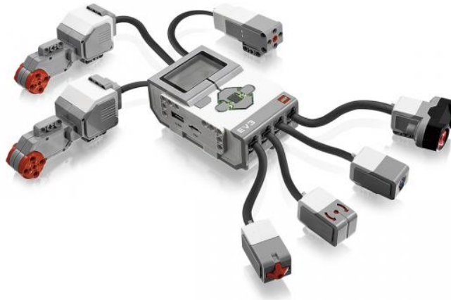
2. ábra: Az EV3 tégla motorokkal és érzékelőkkel
